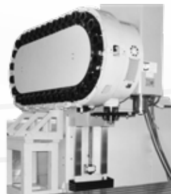
Werkzeugwechsler mit 30 oder 40 Magazinplätzen
