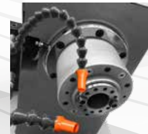
Ringkühl Düsen im Spindelkopf integriert
