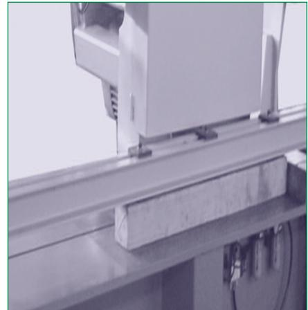
Langschnittsäge mit motorischem Kettenantrieb
