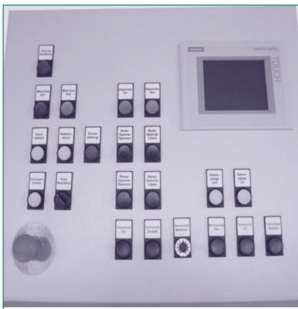
Bedienpult mit Farbdisplay und Funktionstasten
