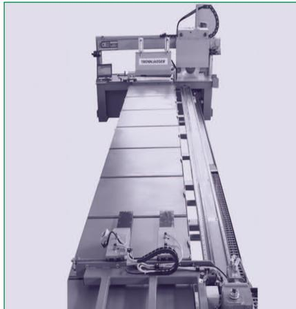
Pushersystem 6000 mm für vollautomatischen Betrieb mit Doppelgreifer-System
