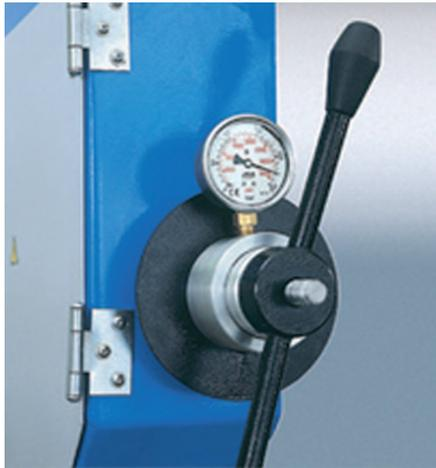
Bandspannung mit Manometer
