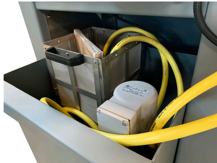
Kühlwassersystem mit Filter, seitlich herausnehmbar
