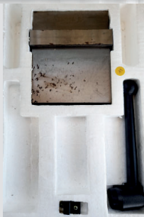
Nr. 11: mech. Schraubstock 160 mm breit / 45 mm hoch
