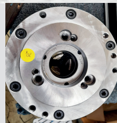
Nr. 28: Dreibacken-Drehfutter BISON DIN 55029 Ø160 mm KK4
