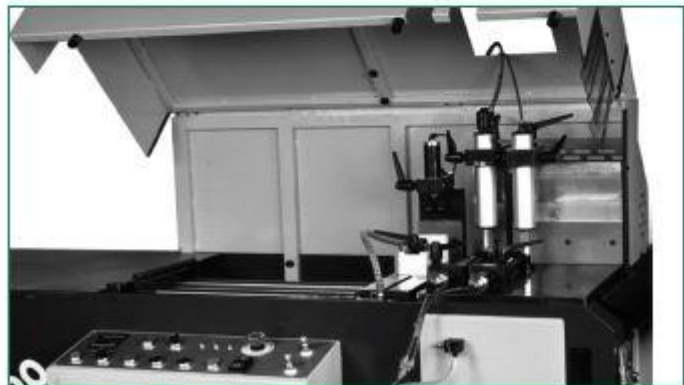
Horizontale und vertikale Spanneinheit
