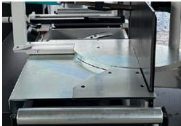
Zaciskanie materiału, a następnie obracanie jest możliwe. Poziomy cylinder o pełnym skoku
