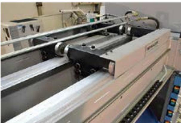
Vertikale Spanner, verschiebbar
