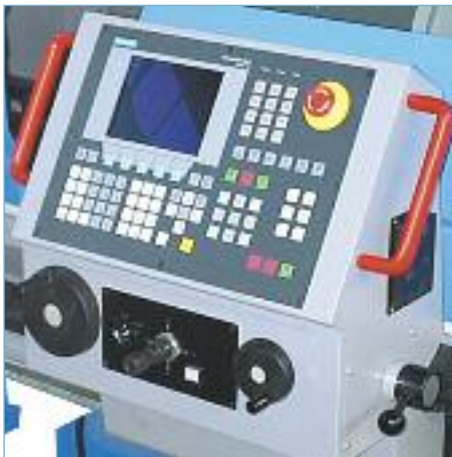
Steuerung und Handräder SIEMENS 802 C 3-Backenfutter zugänglich Innenansicht
