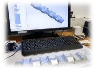
Komplexe Bauteile (zum Beispiel das geschruppte Modell im Vordergrund) werden am CAD/ CAM-Arbeitsplatz programmiert.
