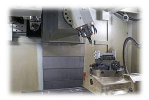
Der verlängerte Z-Weg ermöglicht es, auf dem 5-Achs-BAZ WMC 1100 B Kuben mit 500 mm Kantenlänge bearbeiten.
