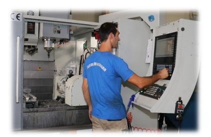
Jüngstes Fräszentrum im Hause Wiedmann ist die Wagner WMC 1100 mit Rund-/Schwenktisch. Durch die Siemens-Steuerung 828 D und Shopmill lässt sich das 5-Achs-BAZ einfach bedienen.
