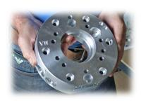
Ein 5-Achs-BAZ ist für die wirtschaftliche Bearbeitung dieser Roboterkomponente zwingend erforderlich. Durch die rundum vorhandenen seitlichen Bohrungen müsste sonst immer wieder umgespannt werden.
